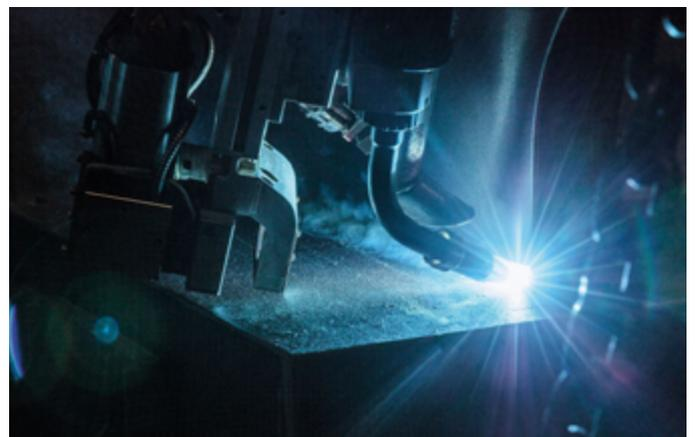
Abb. 1: Mit dem Laserhybrid-Verfahren ist das automatisierte Fügen unterschiedlicher Aluminium- und Stahlteile mit hoher Geschwindigkeit möglich.
