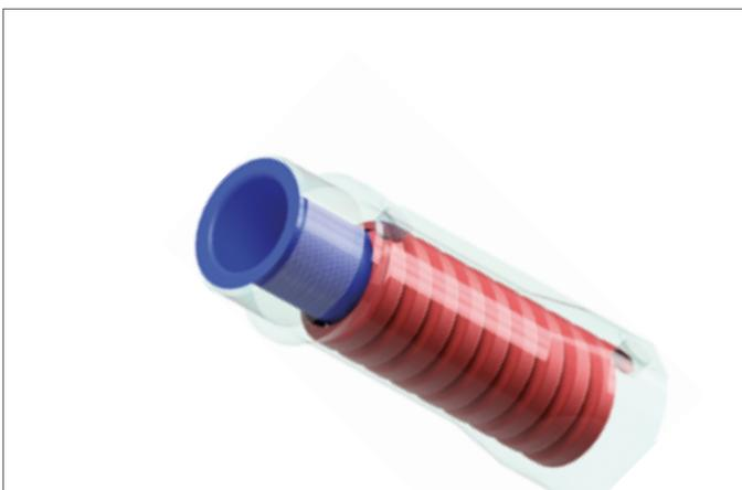
Abb. 3: Integrierter Temperierkanal
