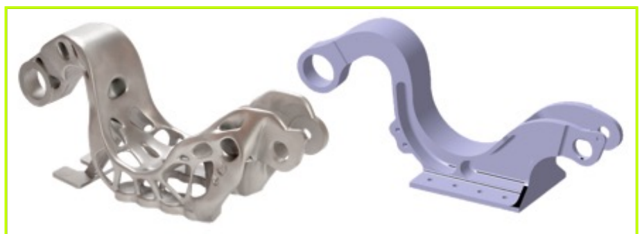
Gewichtsreduzierter Schwanenhalsbügel von SLM (links) und konventionell gefertigtes Teil (rechts)
