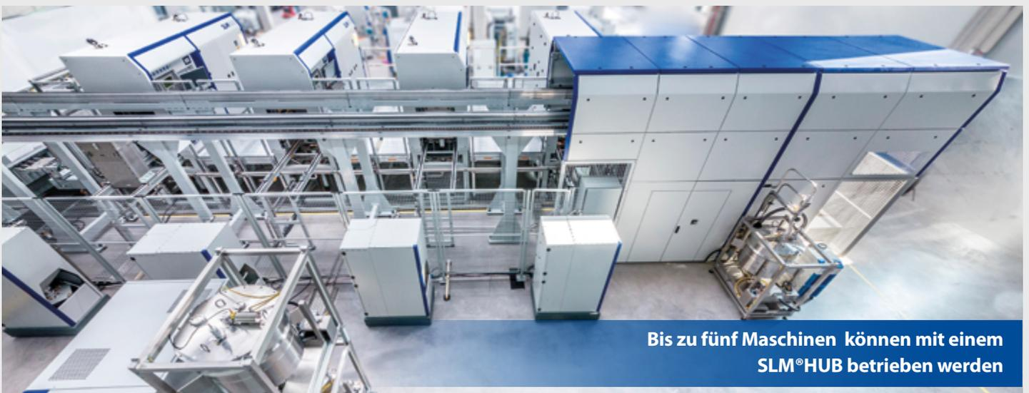
**Bis zu fünf Maschinen können mit einem SLM®HUB betrieben werden**
